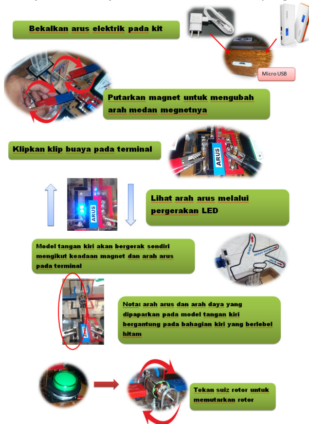
Rajah 5. Proses melabel Kit Motor Elektrik
