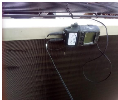
Fig. 2. (d) Outdoor temperature and humidity data logger
