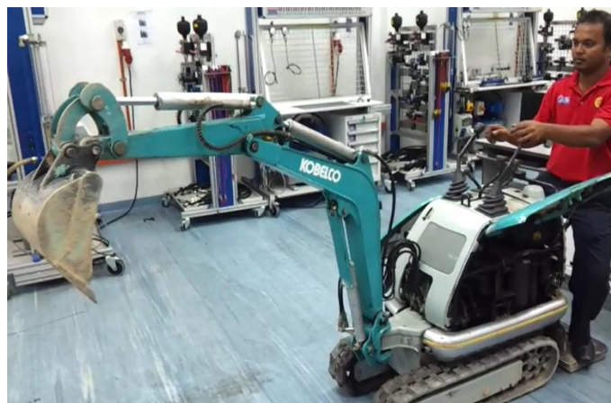
Fig. 16. Manually Operated Mini Excavator
