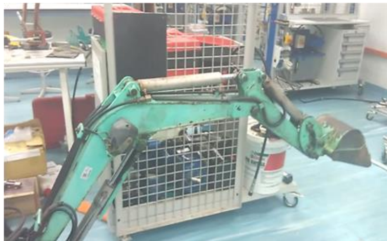
Fig. 19. Mini Excavator's Boom Movement Test
